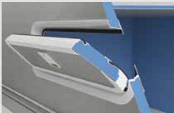
Sportelli esterni Carthago "Isoplus": pannelli dello stesso materiale delle pareti, guarnizioni doppie = isolamento uniforme, massima stabilità
