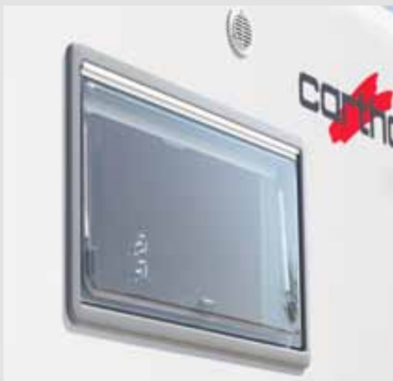
Finestre cellula Carthago: finestre isolanti Seitz S 5 = telaio PU privo di ponti termici, isolamento perfetto
