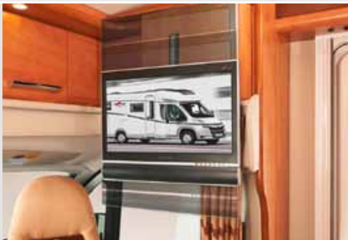
Sistema di estrazione TFT "quick up" modello 4.3 nel sideboard della cabina
