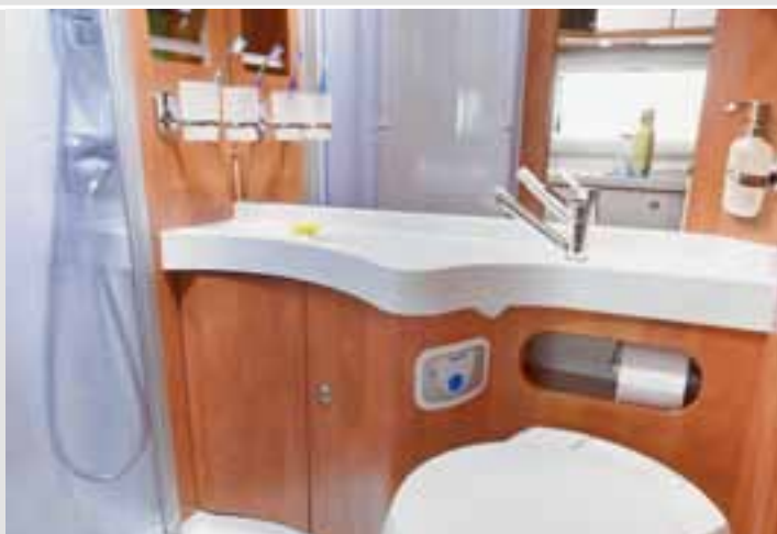
Bagno combinato con doccia separabile a sezione circolare
