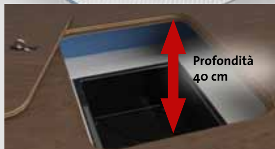
Box di stivaggio nel doppio pavimento: incassati nel doppio pavimento ad una profondità di 40 cm, con riscaldamento aggiuntivo. Accesso attraverso lo sportello nel pavimento (in base ai modelli).
